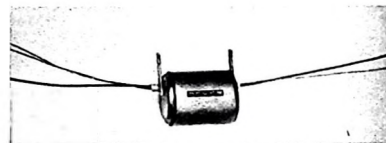
Bild 9. Mikrofonübertrager mit Befestigungsösen zum Einlöten in die Schaltung
